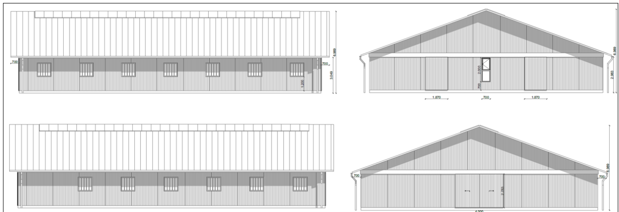
Figur 6 Tegningsmateriale fra ansøgningen - facadetegninger af hestestalden.
