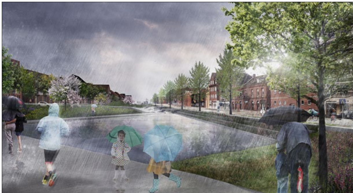
FREMTIDIG SITUATION - HVERDAGSREGN Ved udgravning af bassinerne dannes der et regnvandsmagasin med permanent vandspejl.
