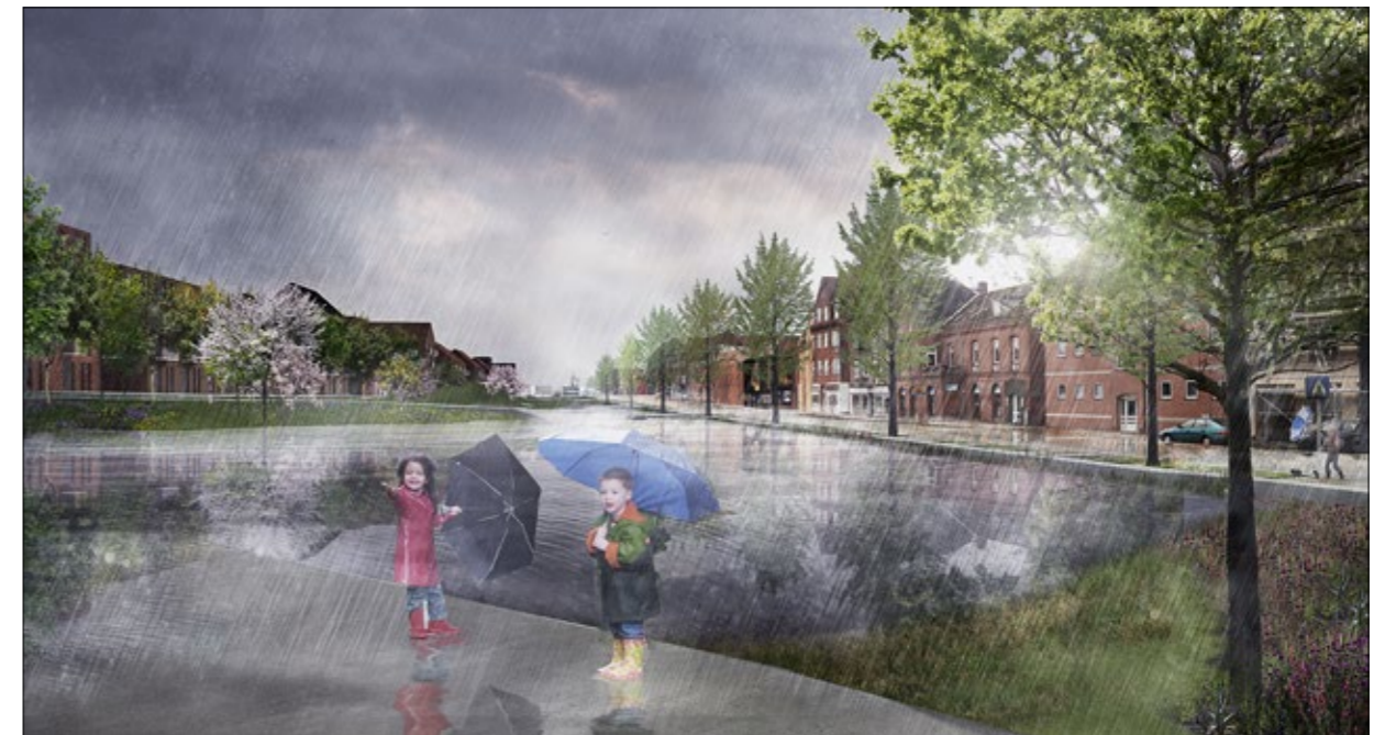
FREMTIDIG SITUATION - SKYBRUD Når skybruddet sætter ind, vil det være parken og ikke byen, der oversvømmes. Skybruddet håndteres ved en kombination af opmagasinering, forsinkelse og afledning til fjorden.
