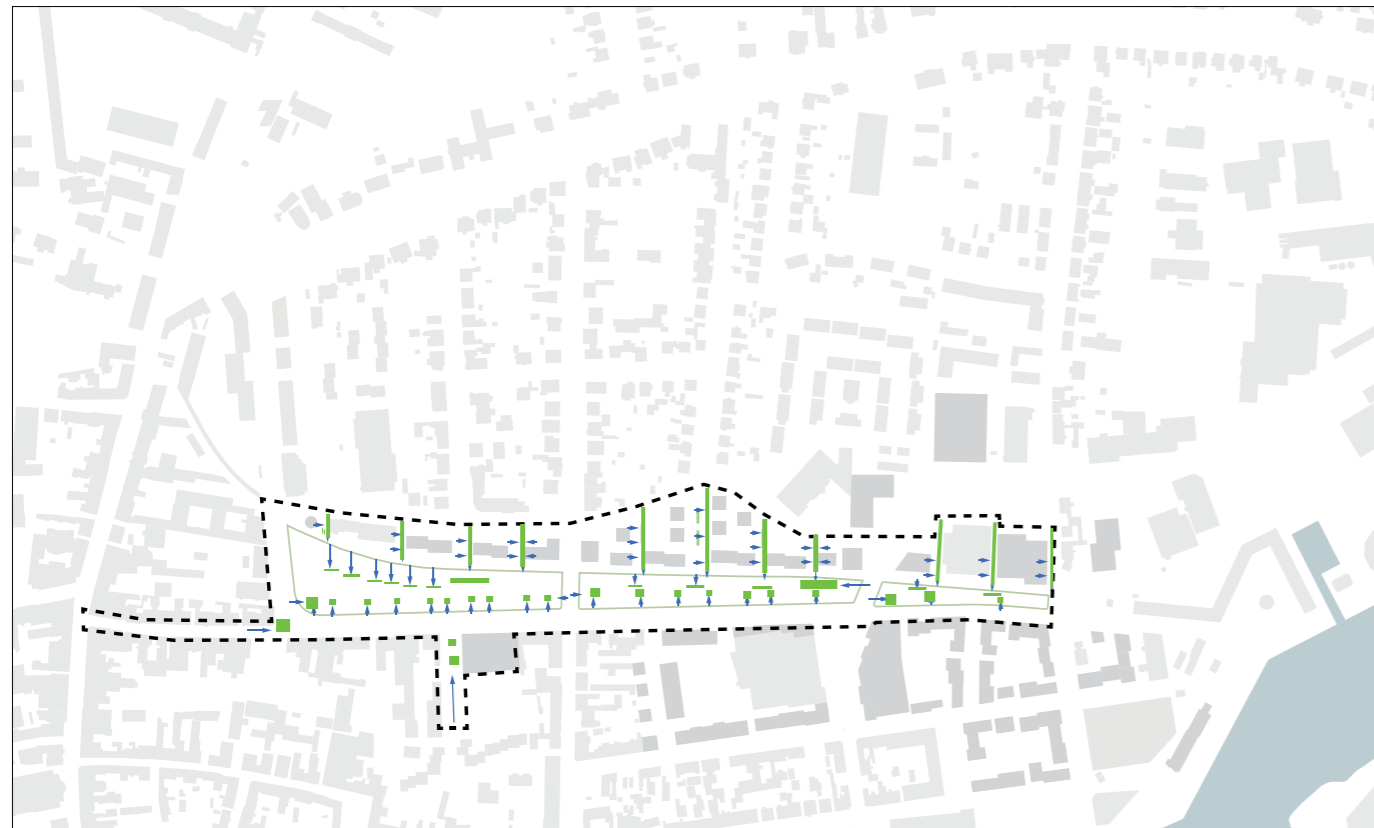
OPTION A | Princip for placering og dimensionering af rensebede. For tilstrækkelig rensning skal rensebedenes størrelse svare til 3-5% af den overflade, som regnvandet kommer fra.
