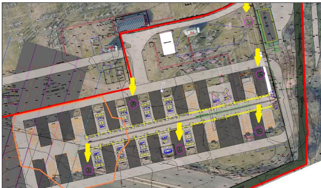
Figur 6: Den orange markering angiver, hvor der terrænreguleres op til 1 meter for at sikre effektiv afvanding til LAR-grøfter.
