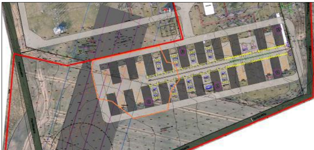
Figur 7: Den orange markering angiver, hvor der terrænreguleres op til 1 meter for at sikre effektiv afvanding til LAR-grøfter. Opsamlingsstryk etableres som afstrømningsvej i den orange markerings nordvestligste hjørne. Beplantnings-Bælte ses på figuren som mørkegrønne markering
