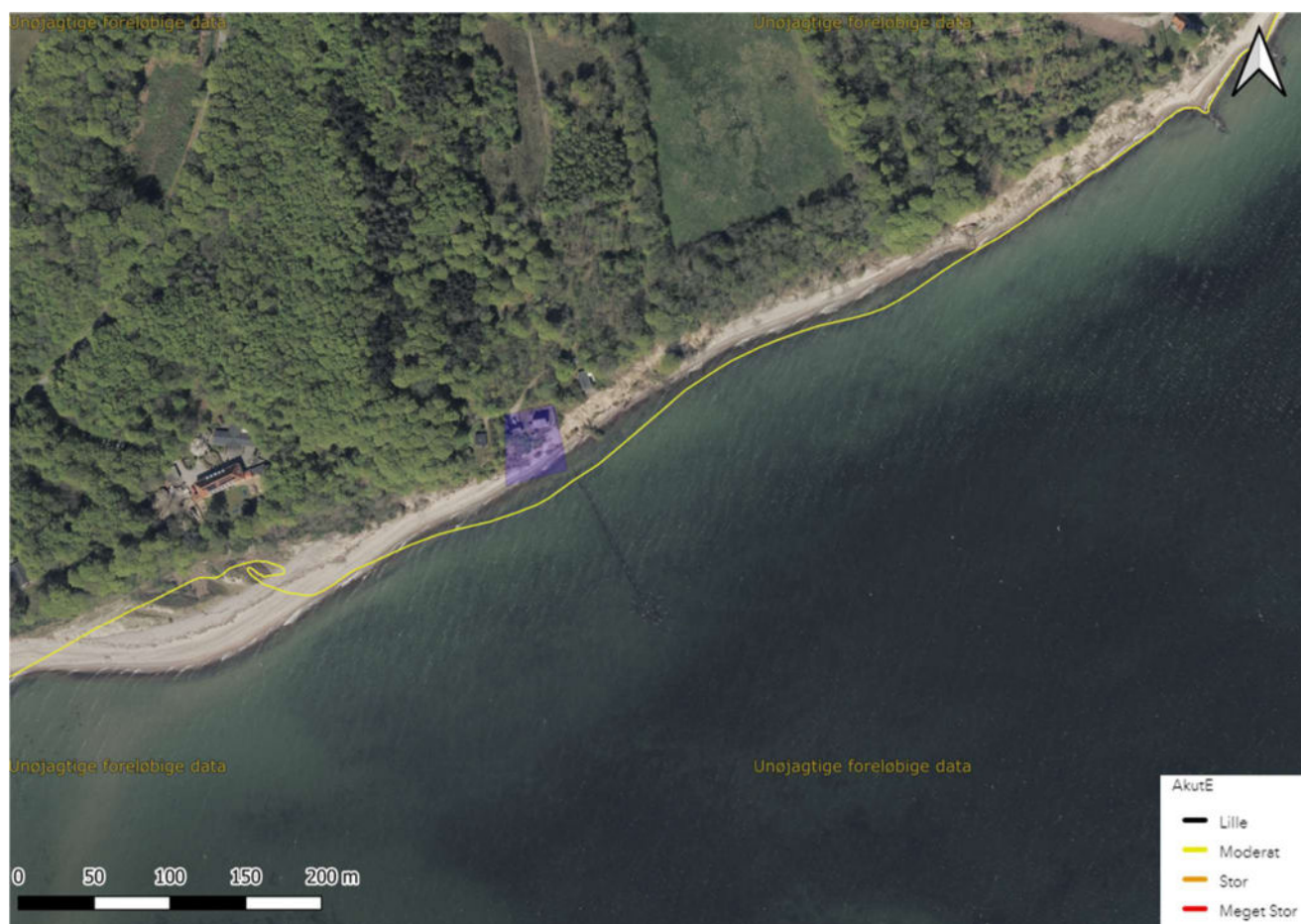
Figur 9: Akut erosionskort med marking af matrikel for Havvejen 63, Kystatlas, Quickfoto fra 2024.
