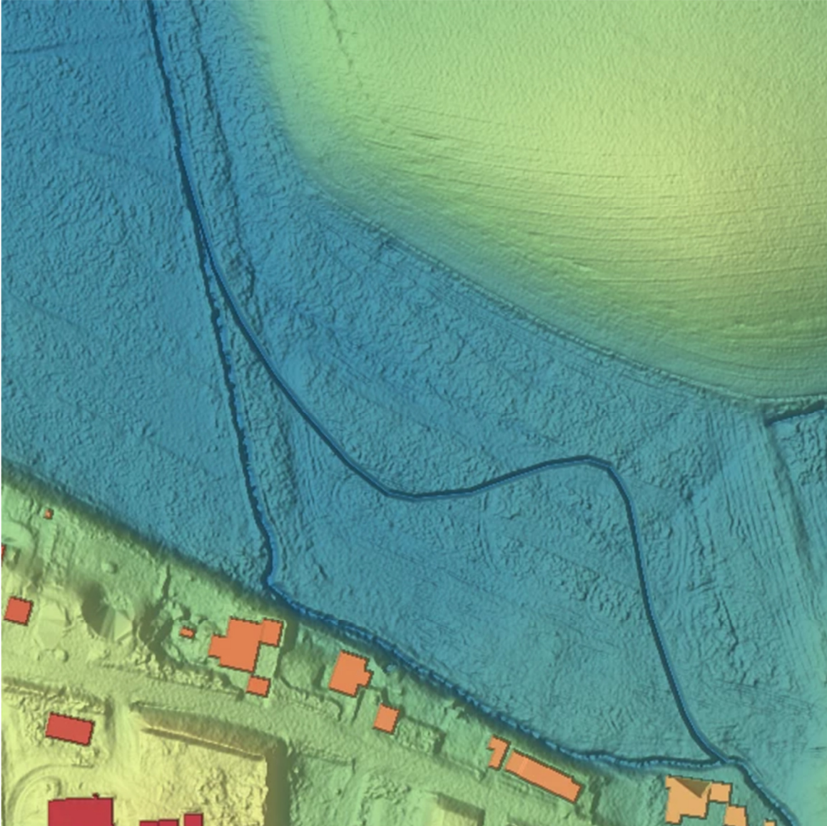
Figur 3. Visualisering af forslag til genslyngning af Lunding Bæk med følgende dimensioner: længde: 250 m, bundbredde: 0,7 m, anlæg 1:1 og hældning 3 %.
