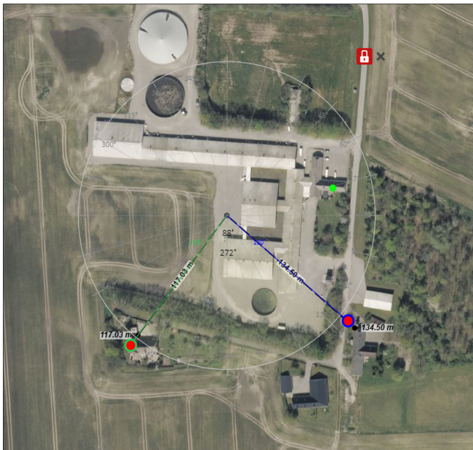
Figur 3 Placering af stalde og nabobeboelser med angivelse af lugtcentrum, retning og afstand.
